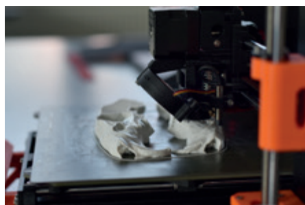
Vlastní tisk staženého modelu lebky hlodavce. Díky nastavení tisku a vnitřní „děrované“ struktuře lze ušetřit tiskový materiál.
